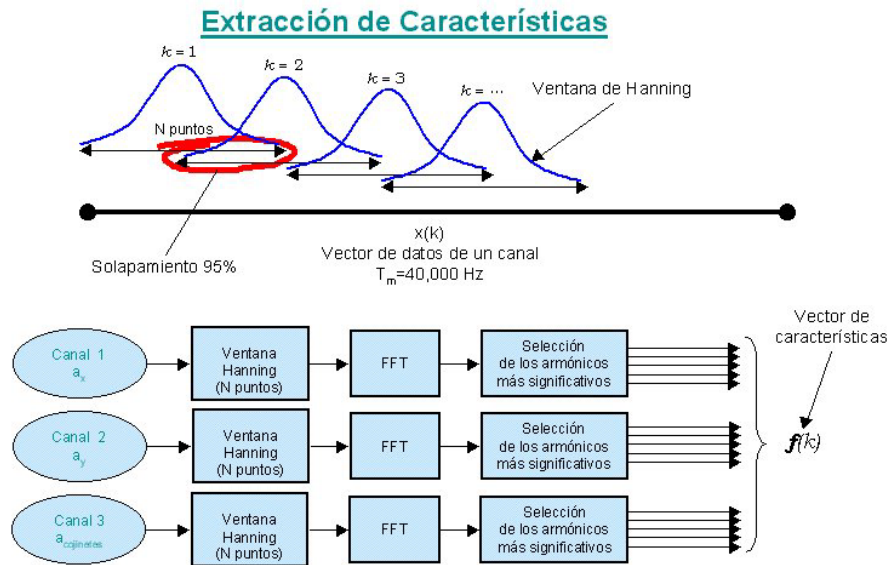
Figura 6.3: Diagrama de bloques de la etapa de extracción de características en el Caso 1.
